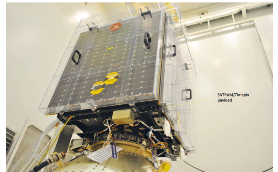
Družice ESA Proba-V při montáži na nosnou raketu Vega-2 v kosmodromu Kourou ve francouzské Guyaně. České zařízení SATRAM/Timepix je integrováno do družice z vnější strany.
